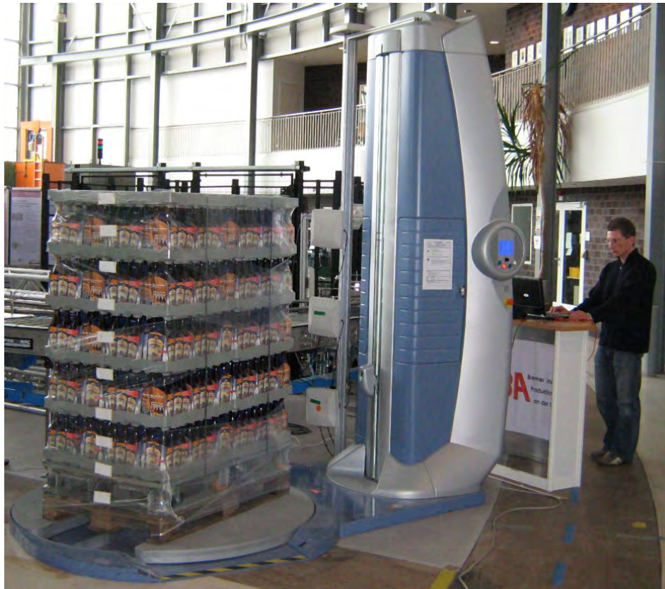
Bild 2.6. Versuchsaufbau mit 10 Tags an einer rotierenden Palette
