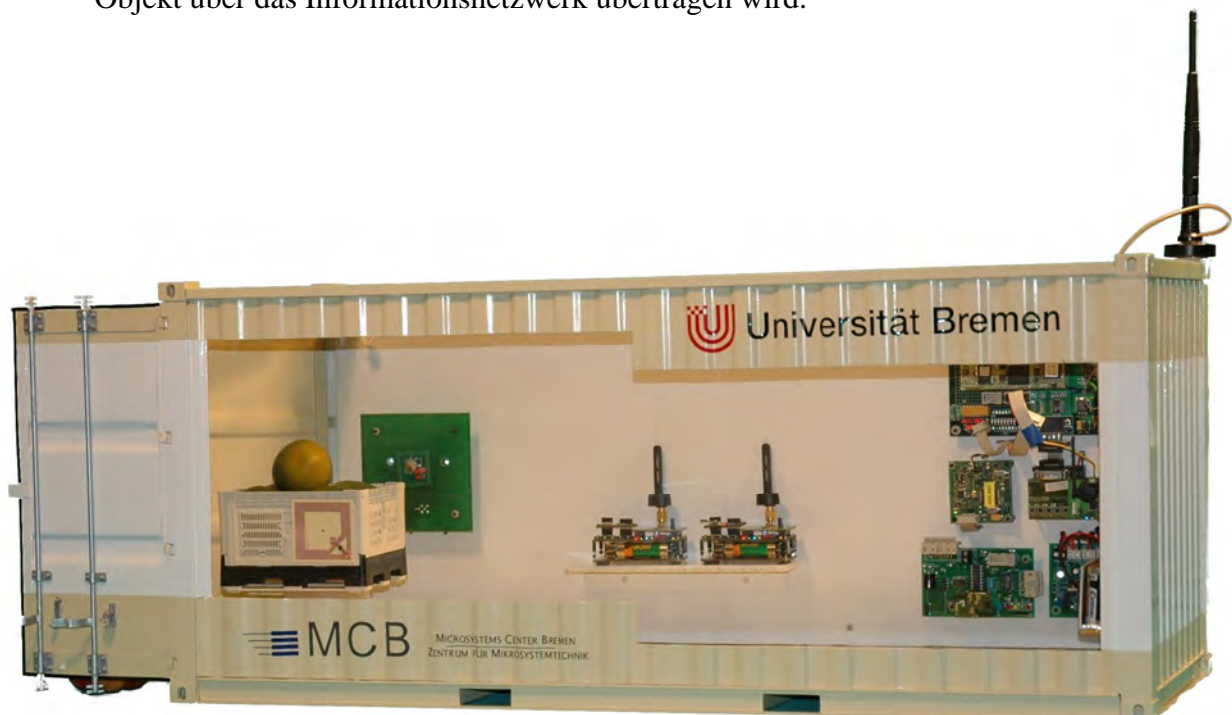
Bild 1.1. Modell des intelligenten Containers im Maßstab 1:8 mit RFID Reader (links), drahtlosen Sensorknoten (Mitte) und Prozessoreinheit (rechts). Die Einheit zur externen Kommunikation befindet sich an der rechten Seitenwand (nicht sichtbar).
